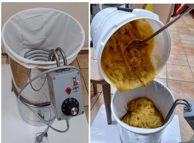
Slika 16: Naprava Melitherm in prestavljanje medu v napravo.
